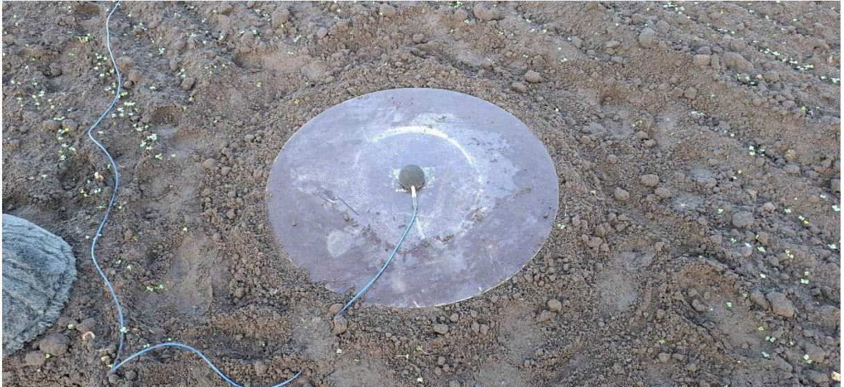
Abbildung 4.2: Foto vom Mikrofon, positioniert auf der schallharten Platte
