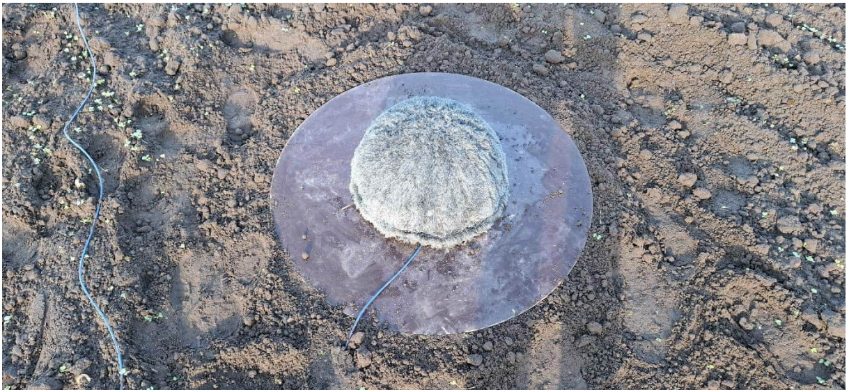
Abbildung 4.3: Foto vom Mikrofon, positioniert auf der schallharten Platte, mit sekundärem Windschirm
