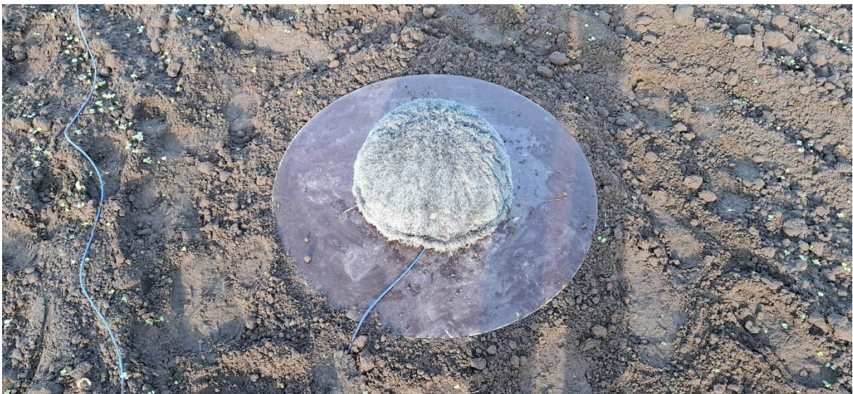
Abbildung 4.3: Foto vom Mikrofon, positioniert auf der schallharten Platte, mit sekundärem Windschirm
