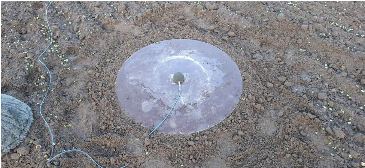
Abbildung 4.2: Foto vom Mikrofon, positioniert auf der schallharten Platte
