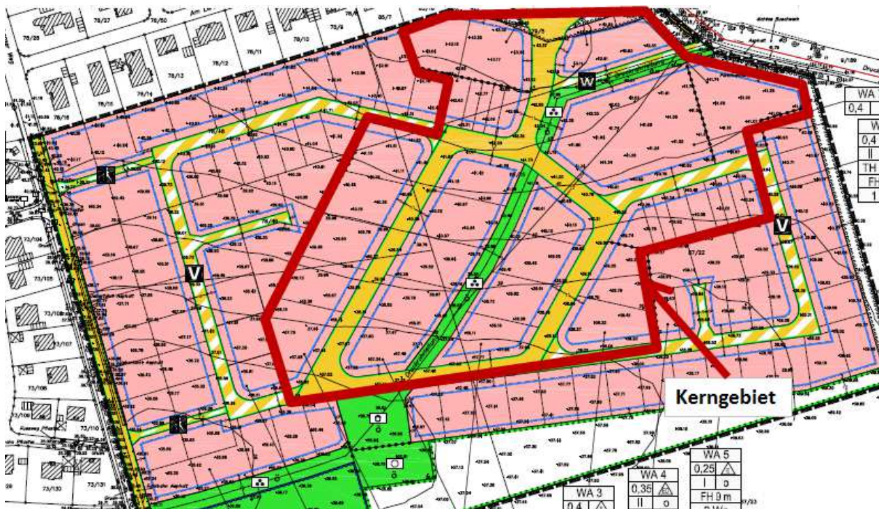
Abbildung 7: Bereich für Wärmesystem „verdichteter Bereich“
